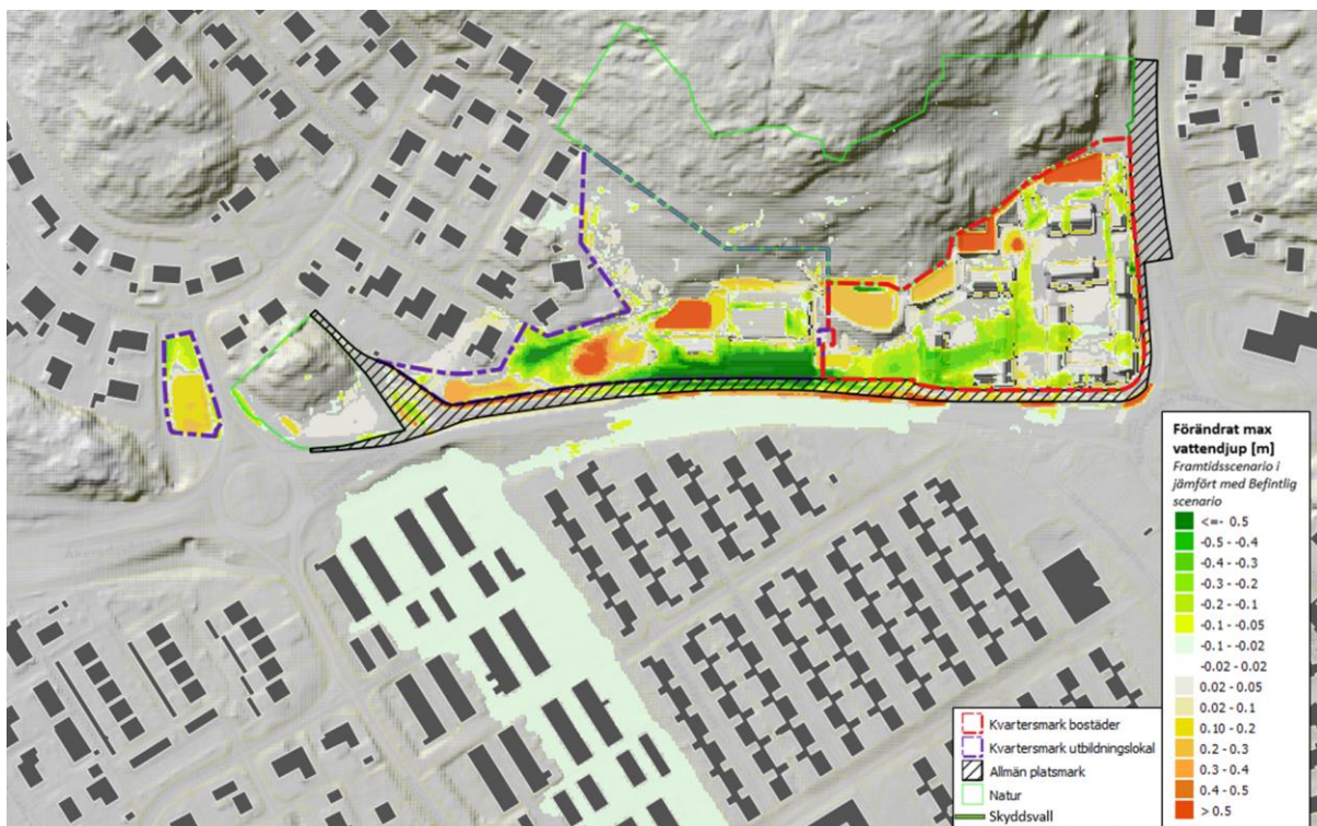
Figur 13. Förändrat maximalt vattendjup mellan befintlig och framtida situation där grön visar en förbättring med lägre vattendjup i framtiden medan orange/röd visar en försämring med högre vattendjup i framtiden. För planområdet kan ökade vattendjup ses i de ytor som är avsatta för att hantera skyfall.
